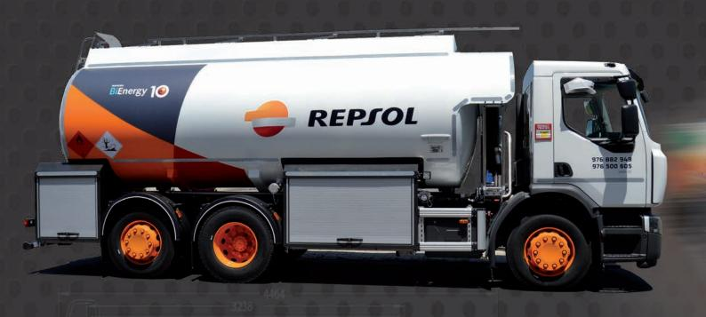
Diferentes secciones de cisternas con bajo centro de gravedad fabricadas en aleación de aluminio con una tara muy baja de todo el carrozado.
